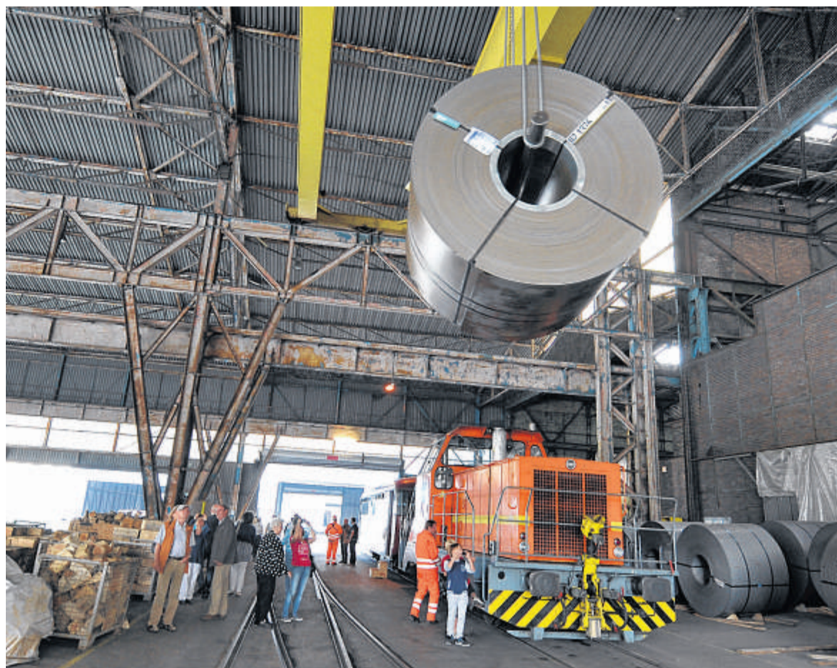
Schweregewicht am Haken: Bei der Firma Siefert werden Coils verladen. Sie sind bis zu 30 Tonnen schwer.
