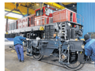
Leicht verschoben: Arbeiter bringen ein Drehgestell in Position
