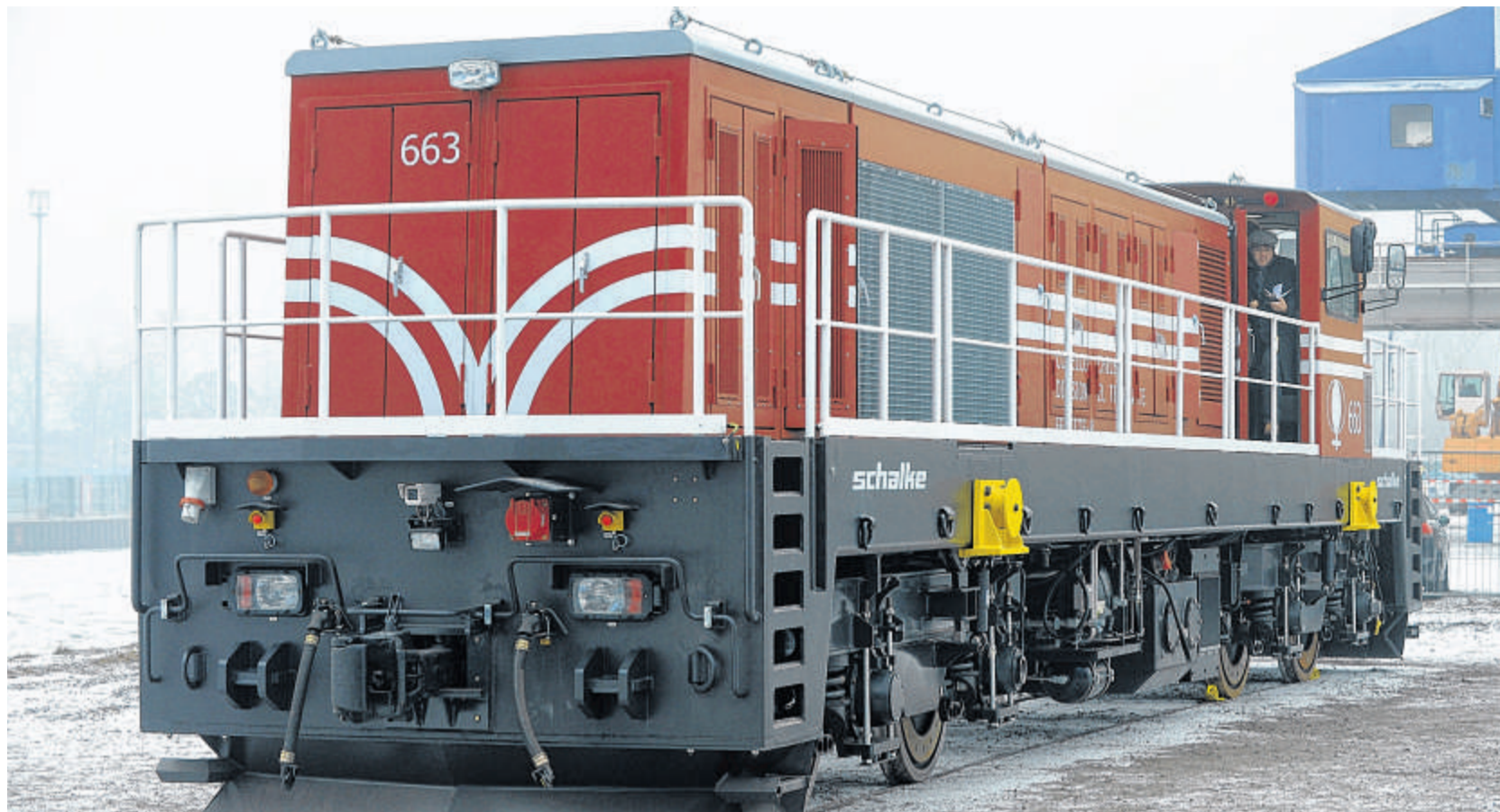
18 Meter lang, 1800 kW stark und 108 Tonnen schwer – die Daten von Lok Nr. 663 sind beachtlich. In einem Erzbergwerk in Chile wird sie zum Einsatz kommen. Fotos: Martin Möller
